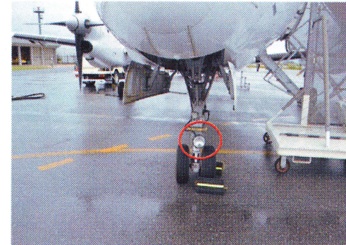
走行灯(タクシー灯)taxi light 地上走行中に誘導路を照らす 飛行中は脚は収納されている 白色
